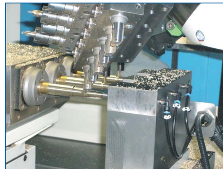
Tournage, moletage et fraisage avec contrepointe
