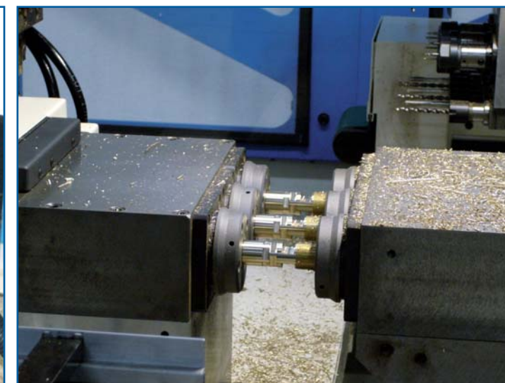
Poupée multibroche et contre-poupée synchronisée
