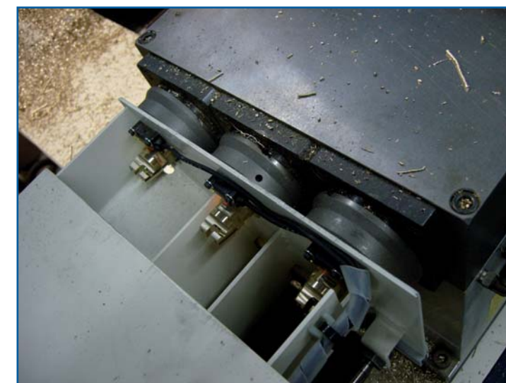
Contre-broche en position déchargement et triage sélectionné.
